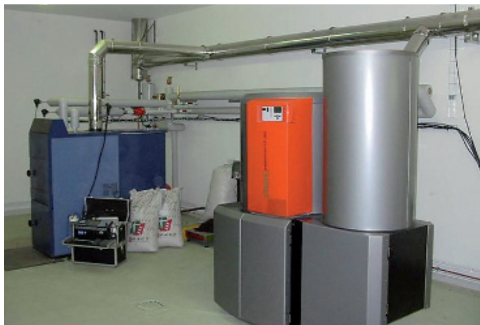
Tests de combustion de granulés en laboratoire.
